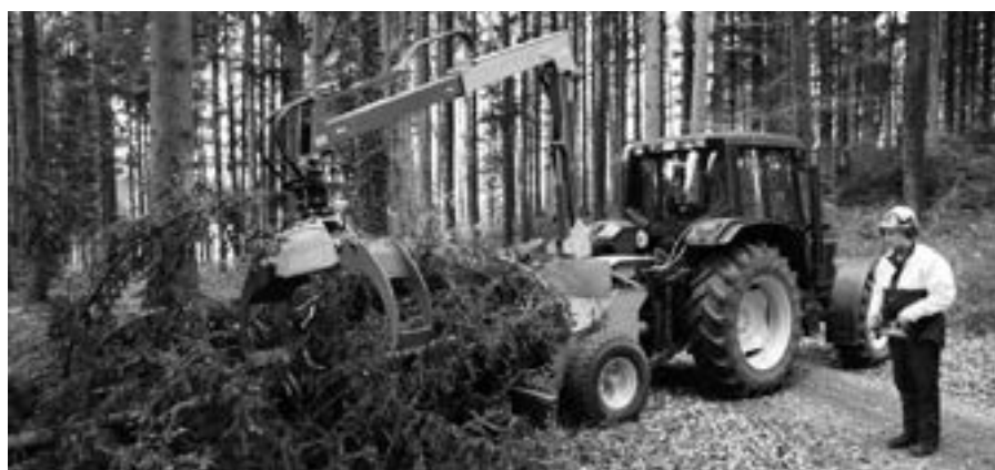
Der «Waldgygant» von Kurt Bachmann kann beim Bäumefällen helfen, die Bäume aus dem Gelände ziehen, sie aufladen und transportieren.
